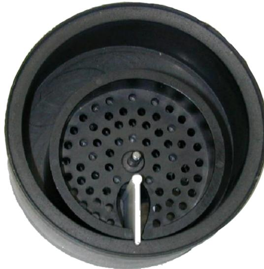
Wasserzähler mit einem Flügelrad. Die Drehzahl des Flügelrades ist direkt proportional zur Fließgeschwindigkeit des Wasser.
